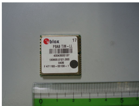
図 5.5: プロトタイプで用いた GPS 受信機 (TIM-LA)
