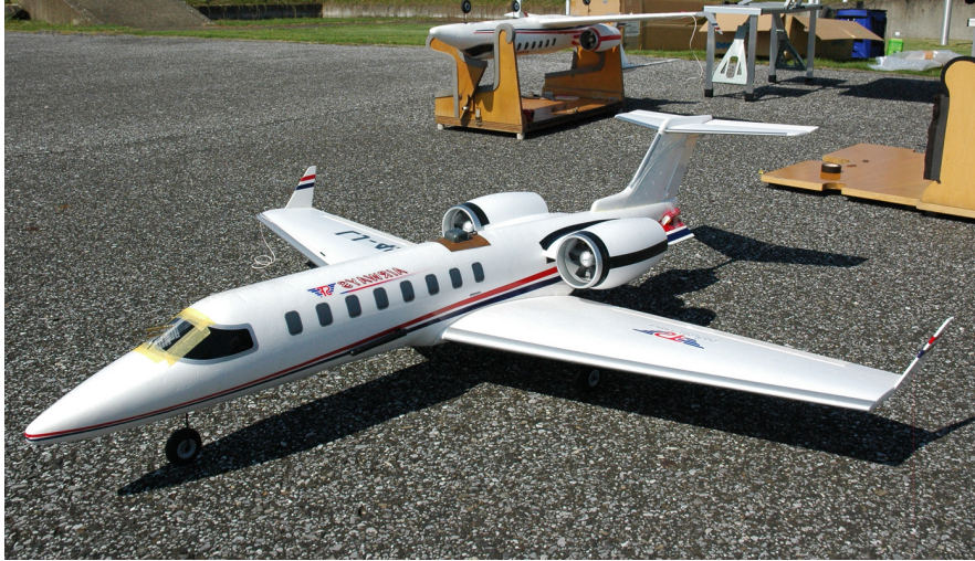
図 1.2: ビジネスジェット型 小型 UAV (エクゼクティブジェット)
