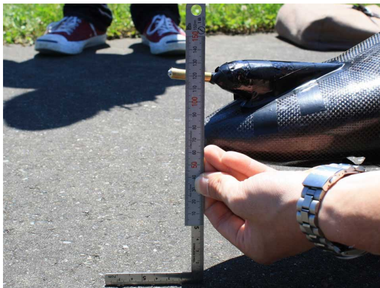
図 4.23: ピトー管の取り付け誤差の測定
