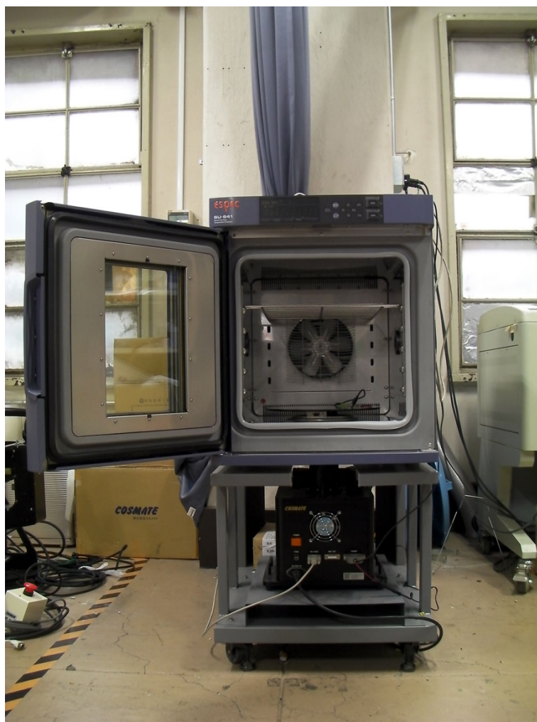
図 B.1: 恒温槽 (Espec SU-641) とレートテーブル (COSMATE TT-DC05)
