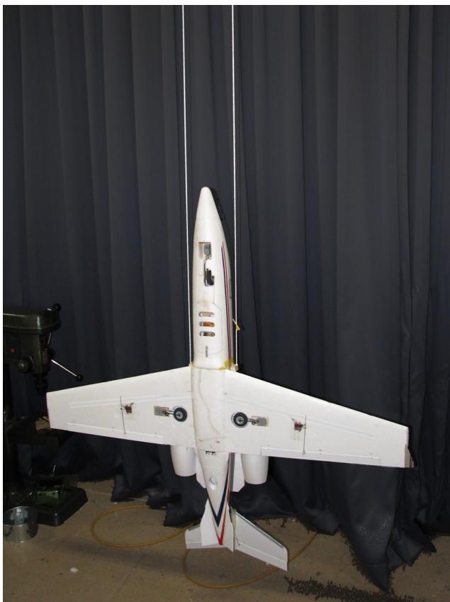
図 3.3: エクゼクティブジェットの慣性モーメントの測定の様子
