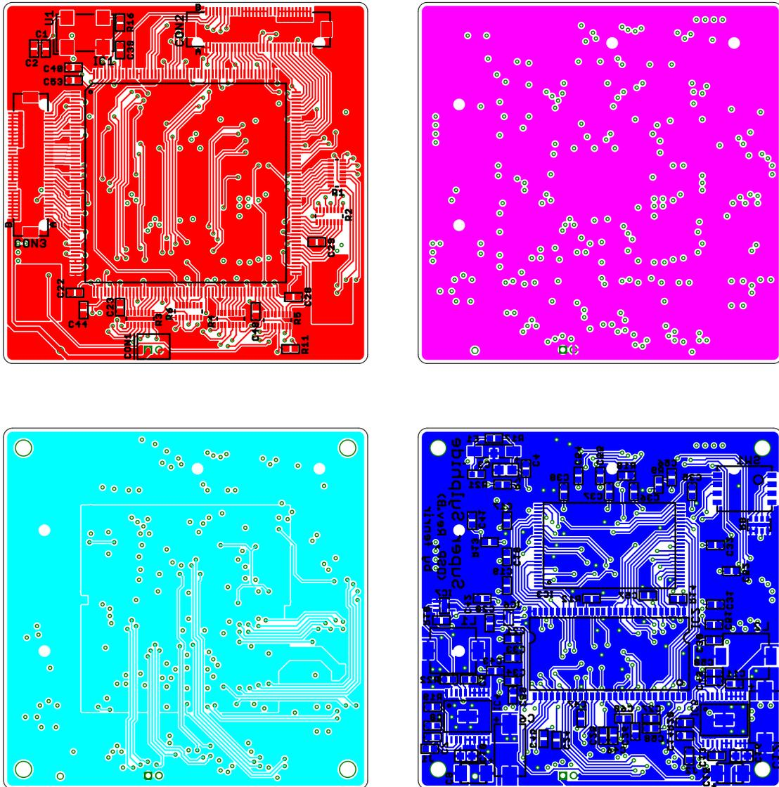
図2 OBC基板(DSP)アートワーク (Scale  $\approx 1.4$ )
